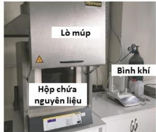
Hình 2.2: Hệ thống nhiệt phân than: (a) sơ đồ và (b) hình ảnh thực tế
