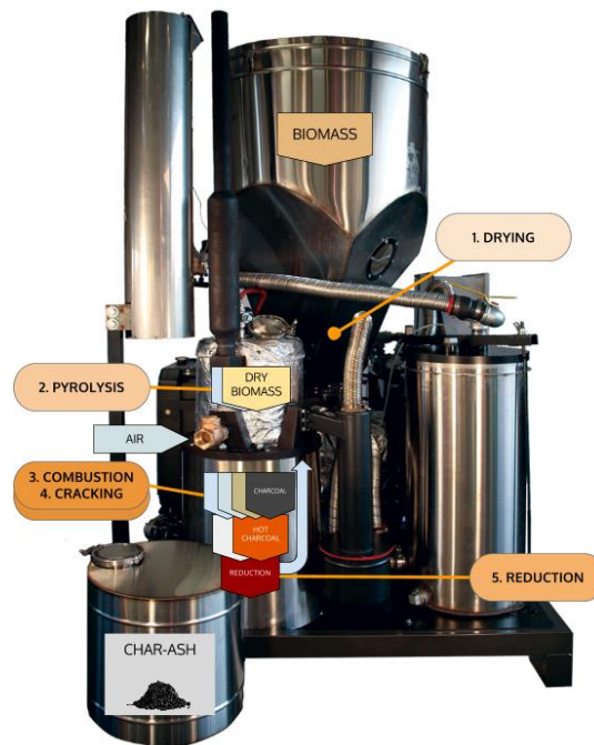
Hình 2.4: Hệ thống Power Pallet 20kW
